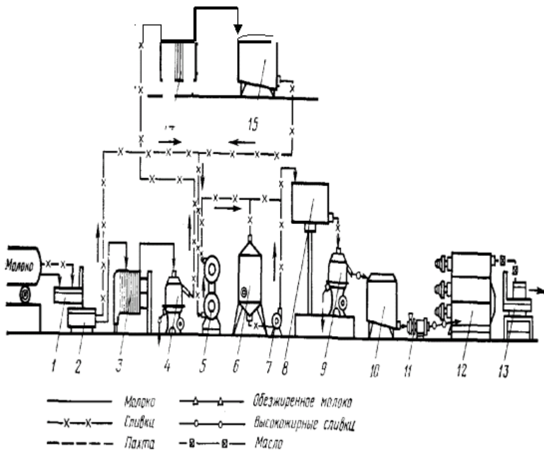
Рис 1. Схема технологического процесса производства сливочного масла методом преобразования высокожирных сливок: 1 — весы; 2 — приемная ванна; 3 — пластинчатый теплообменник; 4 — сепаратор-сливкоотделитель; 6 — трубчатый пастеризатор; 6 — дезодорационная установка; 7 — насос для сливок; 5 — напорный бак; 9 — сепаратор для высокожирных сливок; 10 — ванна для высокожирных сливок; 11 — ротационный насос; 12 — маслообразователь; 13 — стол и весы; 14 — охладитель пластинчатый; 15 — емкость для резервирования сливок.
